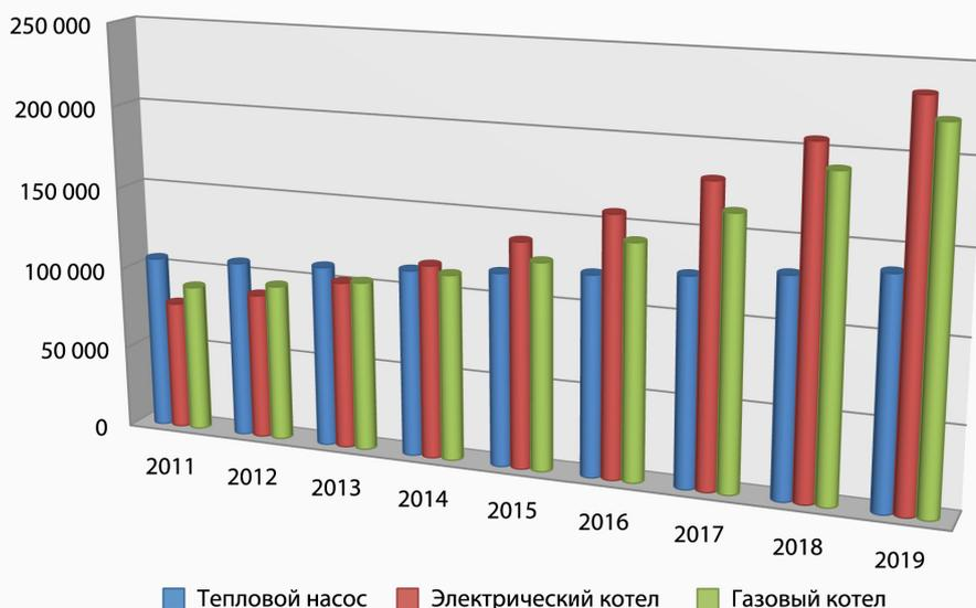
Данный график показывает, что первоначальные капиталовложения максимальны для теплового насоса, но затраты на эксплуатацию и обслуживание приводят к окупаемости теплового насоса, по отношению к газовому и электрическому котлу уже на третий год.
