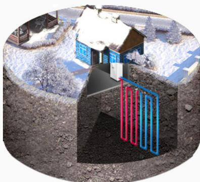
Вертикальное отверстие (50-100 метров), бурится в земле, туда внедряется труба (зонд) с U-образным изгибом внизу. Расстояние между скважинами минимум 6 метров. Каждая вертикальная труба будет подключена к горизонтальной подземной трубе, рабочая жидкость будет циркулировать в замкнутой системе. Нужно отметить, что данный вид наружного контура является самым дорогостоящим.
